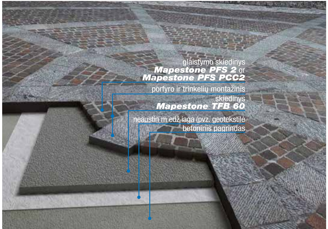
Mažos porfiro trinkelės ir natūralaus akmens plokštės paklotos naudojant Mapestone System
